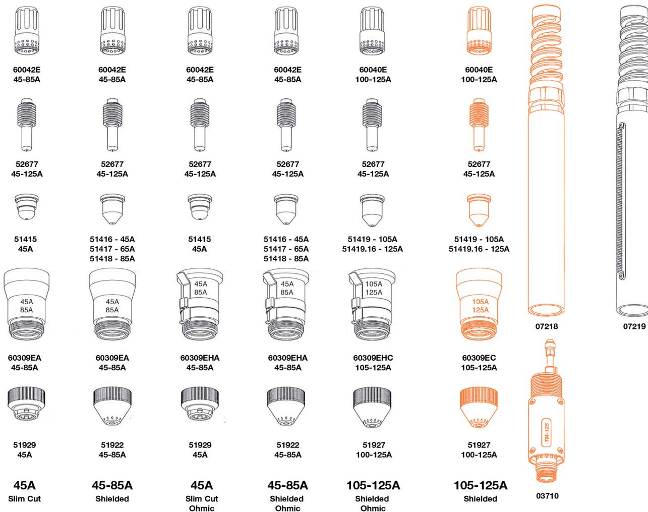
**Slim Cut** - сопла с уменьшенным выходным отверстием
